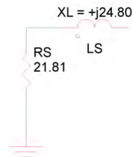
図 9. 並直列変換で直列接続となった信号源抵抗とインダクタのリアクタンス
