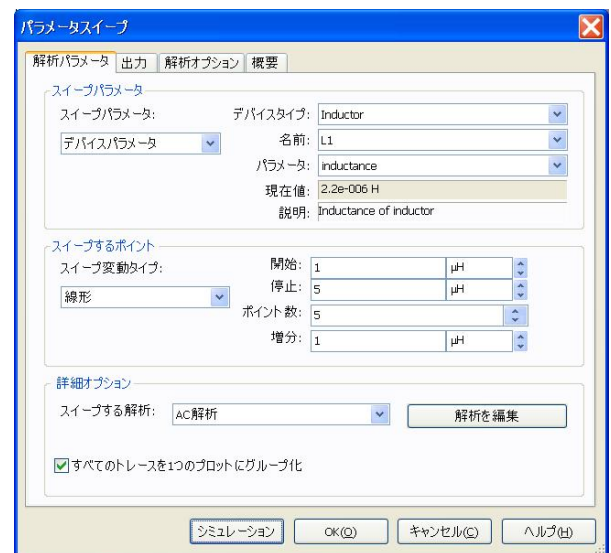
図 16 パラメータスイープ機能でインダクタの大きさを 変えていき最適なポイントが求められる
