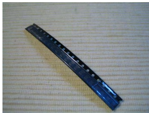
図 2. 10 ビット nanoDAC AD5611AKSZ （静電バッグから取り出したリール）
