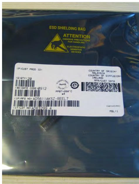
図 1. 10 ビット nanoDAC AD5611AKSZ （入手した状態。静電バッグに入っている）
