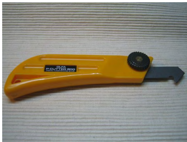
図 2. プリント基板の切断に用いる特殊カッター (OLFA の p カッター)
