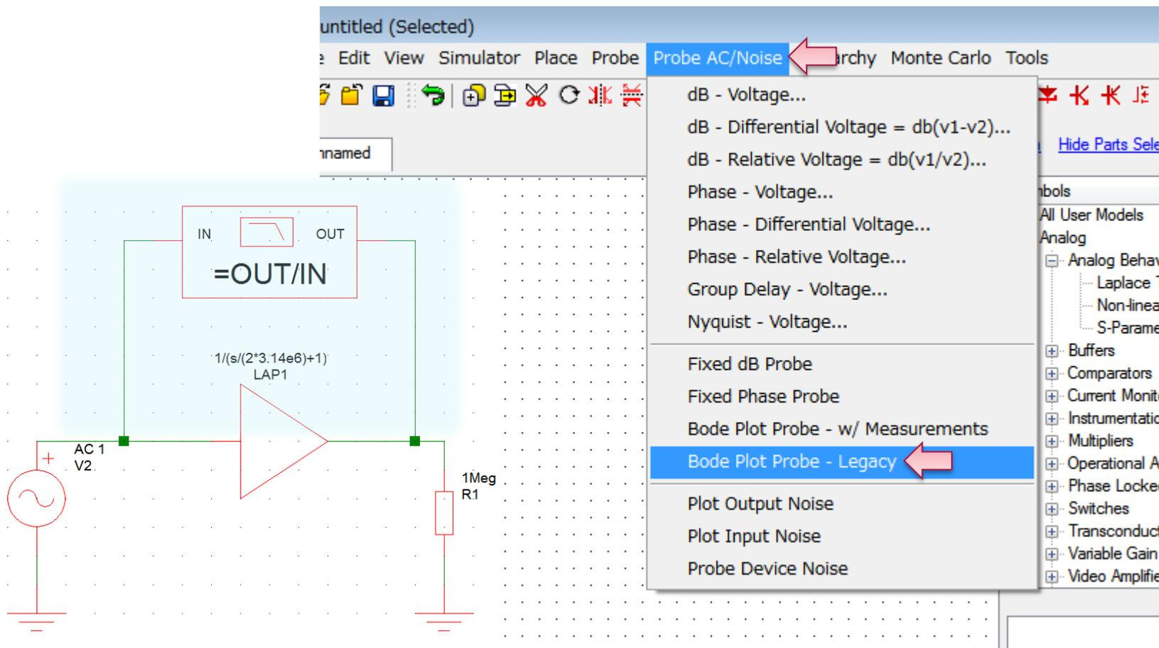
Probe AC/Noise ツールバーからBode Plotter Legacyを選択して配置
