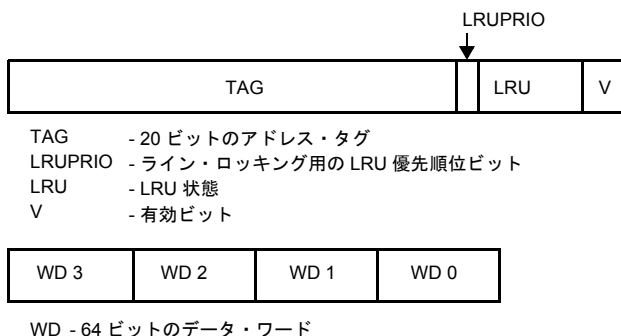
図 6-8. キャッシュ・ライン — タグ部分とデータ部分
