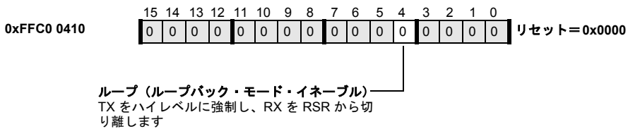
図 13-3. UART モデム・コントロール・レジスタ
