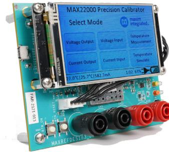
図2. 高精度のキャリブレータ (MAXREFDES183#)
