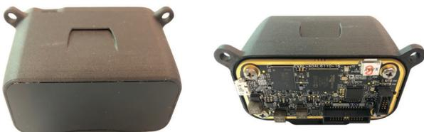
図4. LIDAR向けの評価用モジュール。このEVAL-ADAL6110-16は16チャンネルを集積したADAL6110-16をベースとしています。
