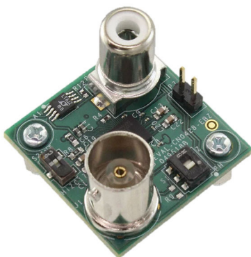
図5. ADuCM355を使用した測定用ボードの外観。BNCコネクタとRCAコネクタを備えています。
