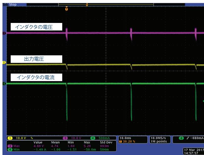
図 4. ADP5071 の動作。Hiccup モードにおける反転レギュレータの動作を示しています。
