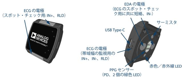
図 2. デモ用に開発された VSM 用の時計。アナログ・デバイセズの一連の製品を使用することにより、消費電力が非常に少なく、小型で軽量な製品を実現できることを示すためのものです。
