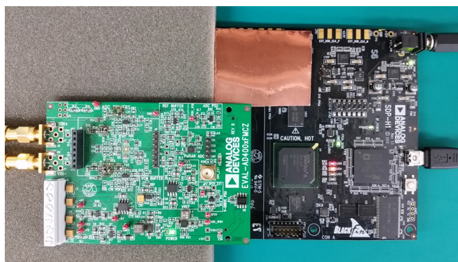
図 3. 銅箔シールドにより VADJ_FMC のインダクタ L5 を覆っています。
