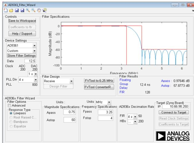
図6. MATLABベースのAD9361 Filter Wizardを用いてADS-B信号用に設計したFIRフィルタ
