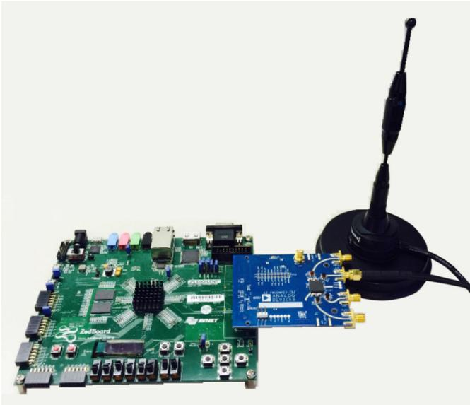
図2. ADS-B信号用のアルゴリズムを検証するためのハードウェア
