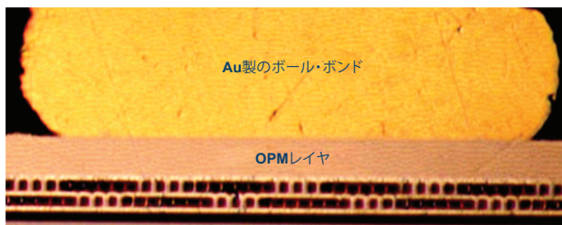
図8. OPMパッドとAuボール・ボンド（195°Cの環境下で6000時間経過しても問題は生じない）
