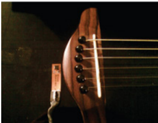
図7. Fender Stratacousticアコースティック・ギターに搭載された加速度センサー
