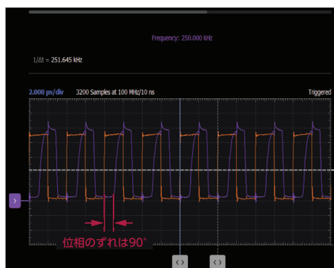
図8. F_{REF} と V_{SQR} の信号波形
