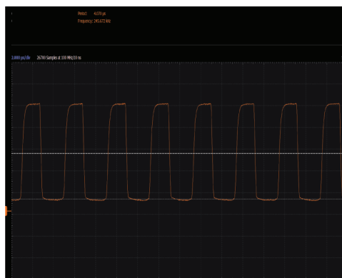
図4. VFC回路の出力
