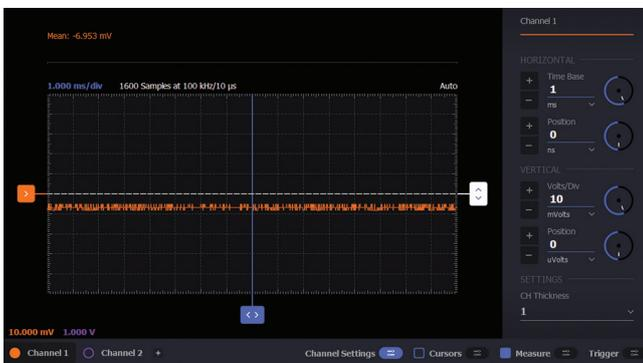
図3.  $T_{SENSE} = T_{REF}$ の場合の電圧波形
