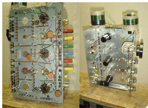
図 B. 3 球ラジオの上面と底面。アルミニウム製のシャーシを使って製作されたブレッドボードです。
