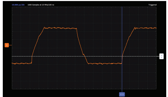
図6. ユニティ・ゲイン・バッファの出力波形。 この波形を基にスルー・レートを計算します。
