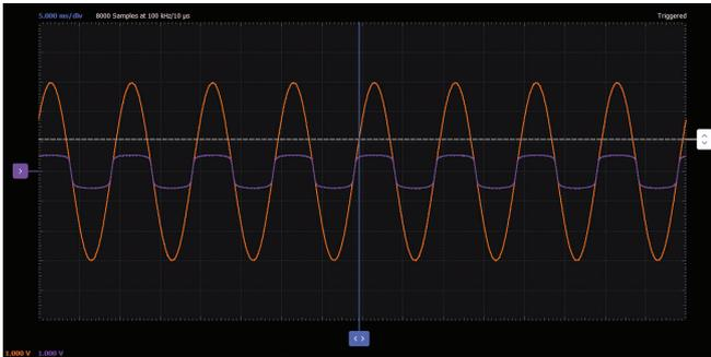
図17. クランプ回路の入出力波形
