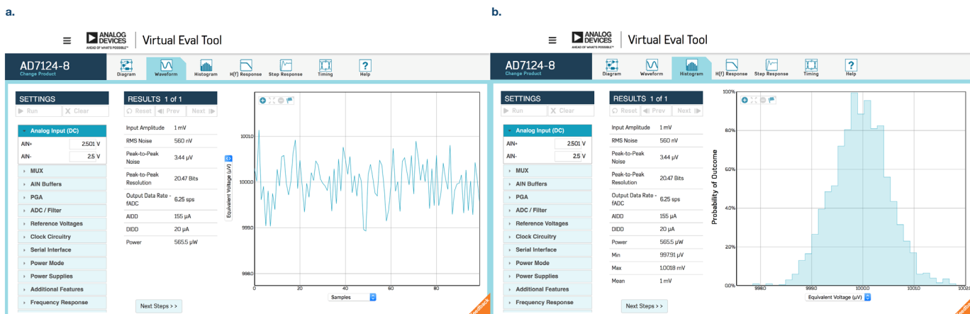
図 2. 入力信号の波形 (a) と入力信号に対応するヒストグラム (b)
