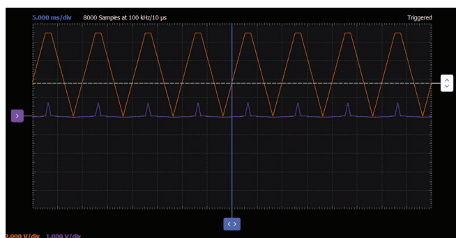
図7. PNPトランジスタのエミッタにおける信号波形
