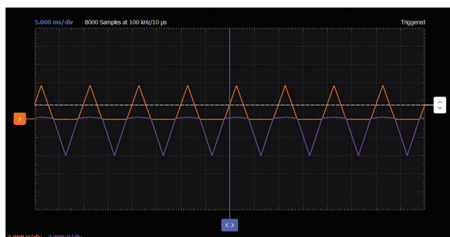
図10. 有効な順方向電圧を下げた場合の信号波形
