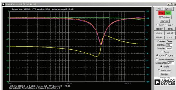
図5. BSFの周波数応答を取得するために設定したボーダ・アナライザ
