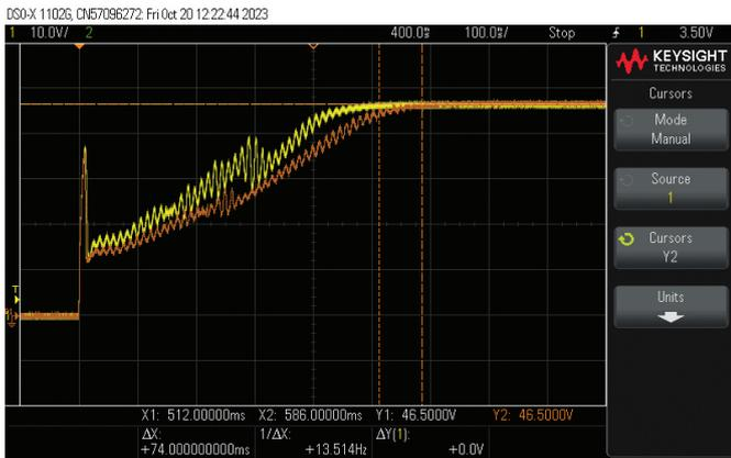
図9.  $C_6 = 2.2\mu\text{F}$ : 負荷電流を0.19Aから0.38Aに変更すると、スタートアップ時間も変化します。
