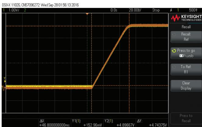
図4. LT8640 : C8 = 0.1μF、負荷電流0A (黄) と4A (茶) でのスタートアップ時間は約50ms
