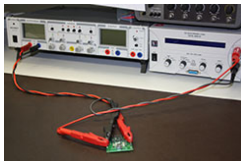
図2. 撚った短いケーブルを使用して構築した実際の評価環境
