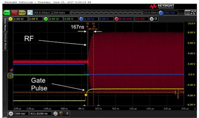
図 4. HPA のターンオン時間の測定結果
