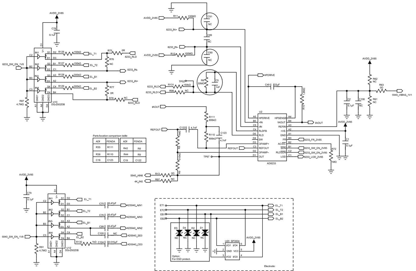
Figure 24. ECG Circuitry
