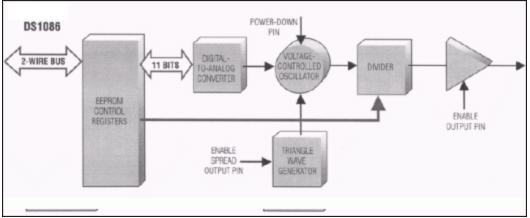
Figure 4. The DS1086 Spread Spectrum EconOscillator.
