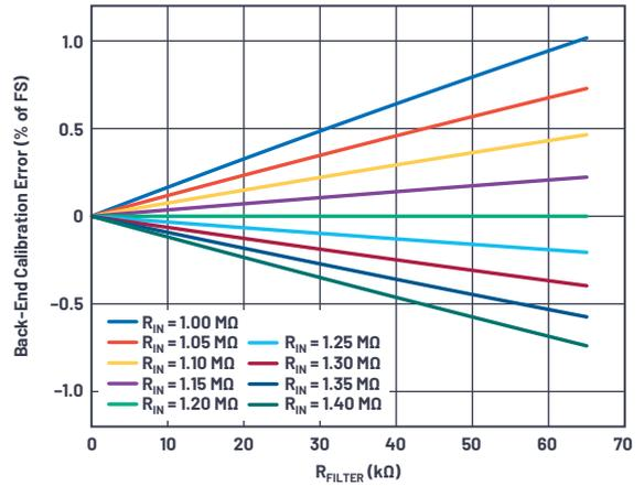
Figure 10. Back-end calibration error depending on the actual  $R_{IN}$  value.
