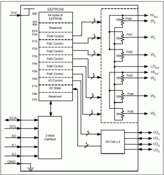
Figure 1. DS3930 block diagram.
