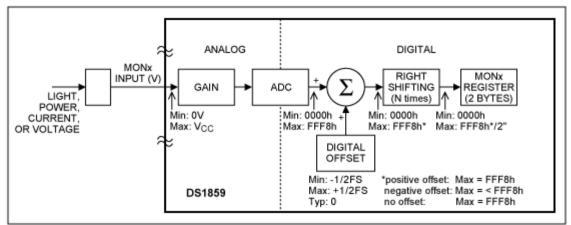
Figure 1. DS1859 MON input block diagram.
