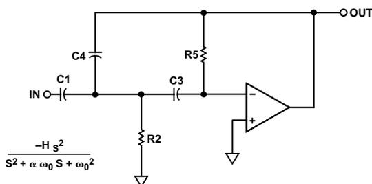
$$\frac{V_O}{V_{IN}} = \frac{-S^2 \frac{C_1}{C_4}}{S^2 + S \frac{(C_1 + C_3 + C_4)}{C_3 C_4 R_5} + \frac{1}{R_2 R_5 C_3 C_4}}$$
