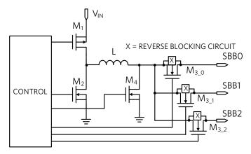
Figure 4. SIMO PMIC Power Block Diagram
