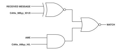
Figure 19-9. Bitwise Acceptance Mask Logic
