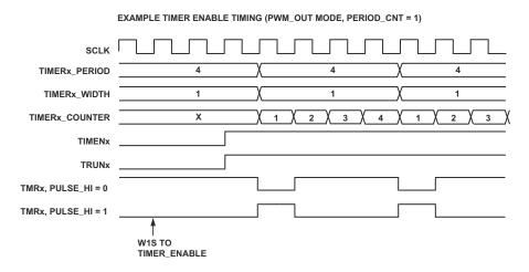
Figure 16-9. Timer Enable Timing
