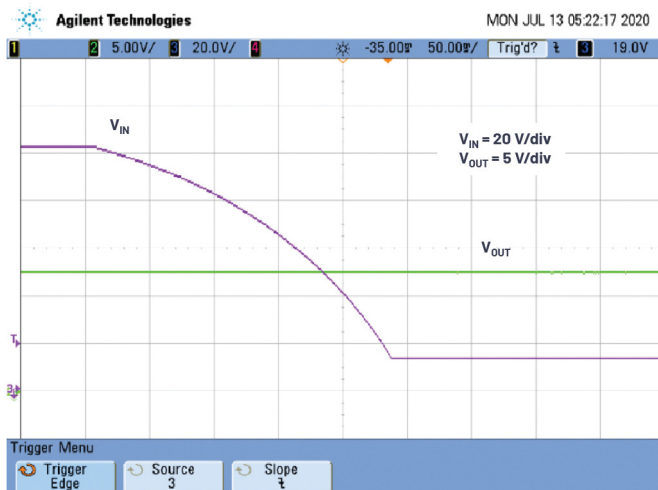
图2. 高压降压偏置电路波形, V_{IN} 为20 V/div, V_{OUT} 为5 V/div, 时间标尺为50 ms/div。
