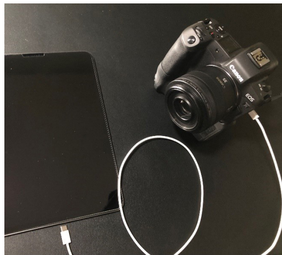
图1. 数码相机通过USB-C电缆连接到平板电脑
