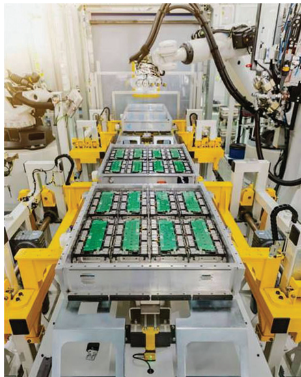
图2. wBMS技术消除了信号线束，从而支持完整电池包的自动化机器人生产
