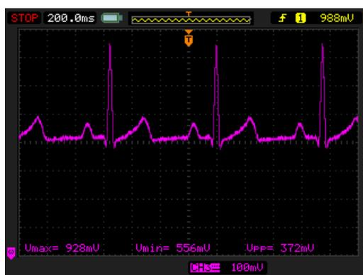
图5. 监护仪模拟输出端显示出从电力线耦合而来的噪声
