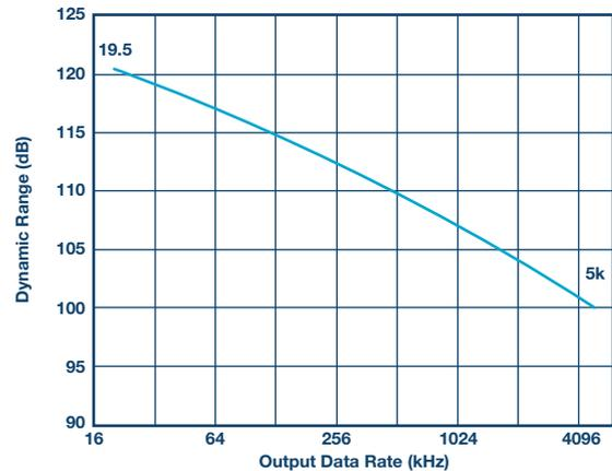
图7. AD7960动态范围与输出数据速率的关系
