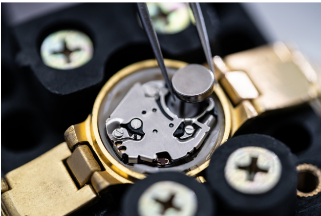
图3. 氧化银电池通常用作手表电池。
