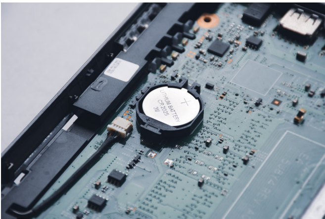
图2. 锂离子原电池：锂-二氧化锰 (Li-M或LiMnO 2 ) 和二硫化锂(Li-FeS 2 )。
