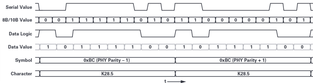
图3 K28.5字符的逻辑输出以及它如何通过JESD204B Tx信号路径传播。
