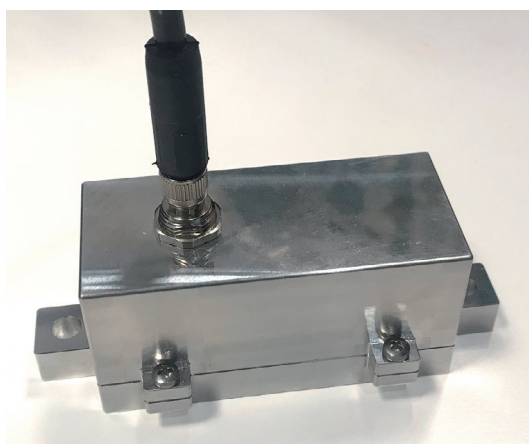
图1. 10BASE-T1L单对以太网状态监测（振动）传感器原型。
