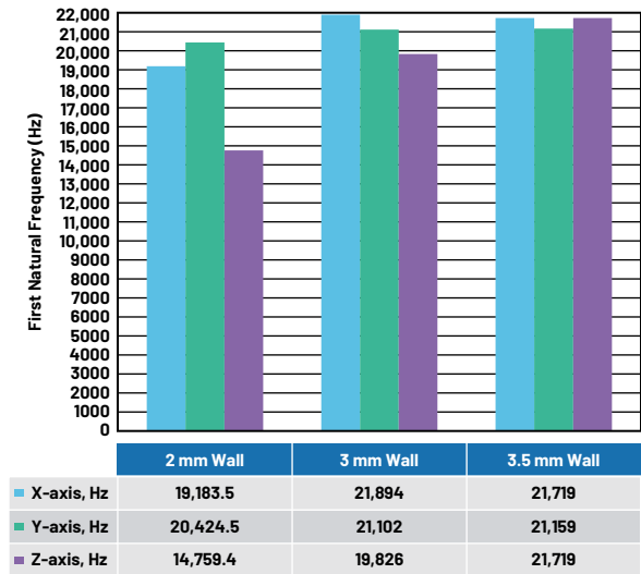
图26. z轴的首级有效固有频率与壁厚的关系。
