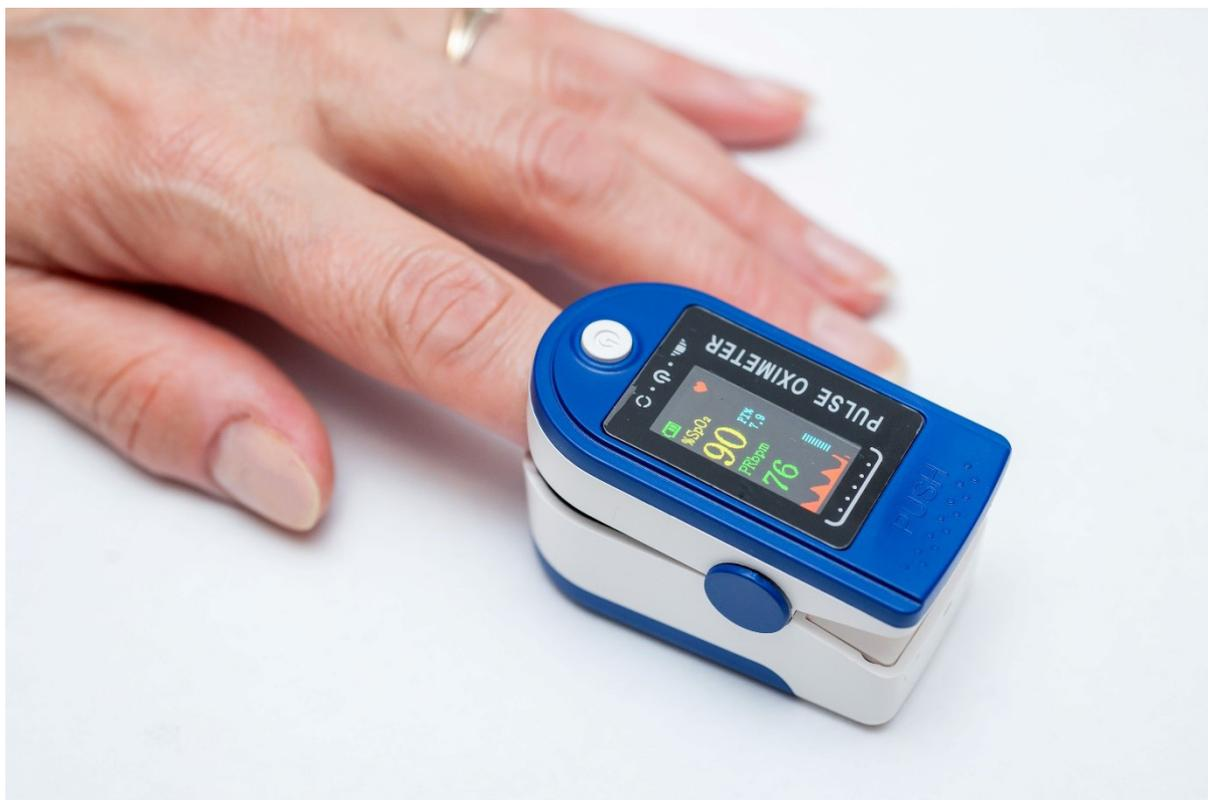
图2: 戴在手指上的脉搏血氧仪测量 $SpO_2$  (资料来源: Shutterstock)
