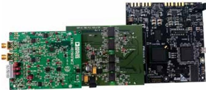
图4. 用于AD7960和SDP-H1的ADN4651隔离电路
