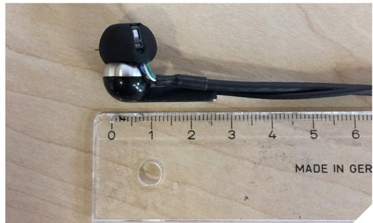
图1. 集成光学传感器和加速度计的测试系统，刻度尺用于比较。
