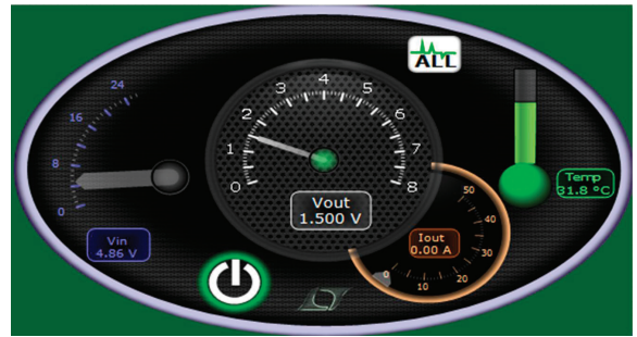
图 2：利用 LTpowerPlay 下的图形控制面板完成的简单监视。
