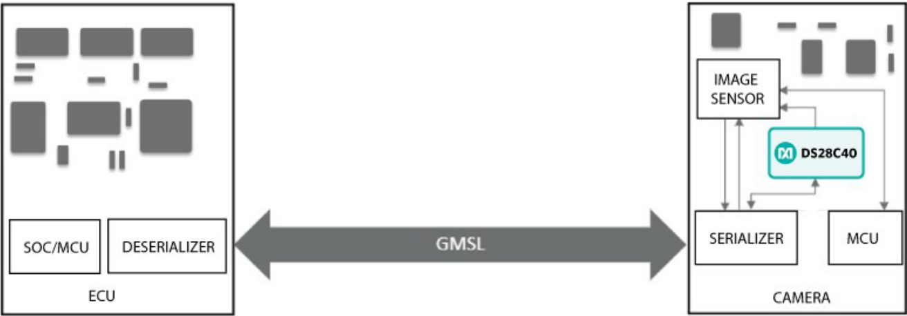
图2. 使用GMSL I 2 C隧穿功能在ECU和摄像头之间进行通信
