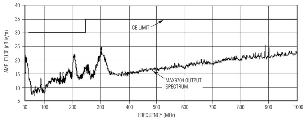
图1. MAX9704 EMI频谱，使用9英寸PCB引线和3英寸双绞线扬声器电缆
