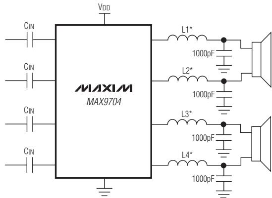
\*L1–L4 = 0.05Ω DCR, 70Ω AT 100MHz, 3A FAIR RITE FERRITE BEAD (2512067007Y3).
