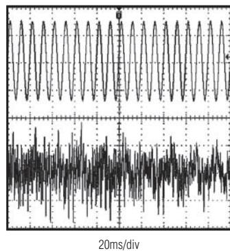
图5. 正弦波与音频信号的RMS比较
