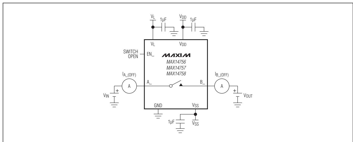
图3. 关断漏电流
