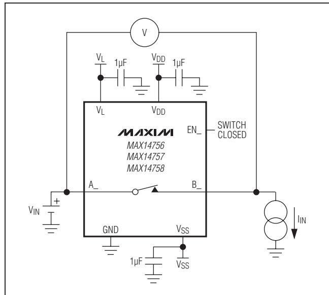
图1. 导通电阻测量
