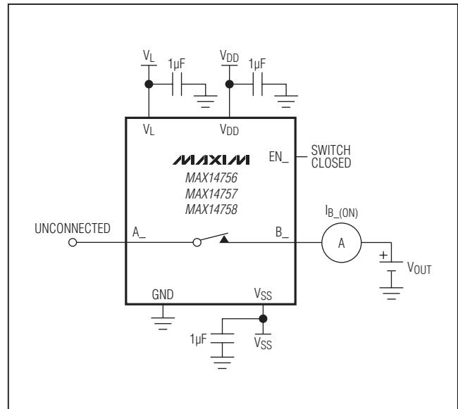
图2. 导通漏电流
