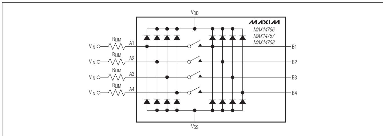
图9. 输入过压和欠压箇位
